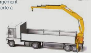
Grue de chargement montée en position centrale
