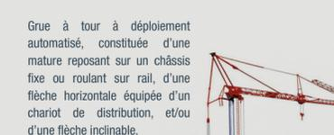
Grue à tour à déploiement automatisé, constituée d'une mât reposant sur un châssis fixe ou roulant sur rails, d'une flèche horizontale équipée d'un chariot de distribution, et/ou d'une flèche inclinable.
