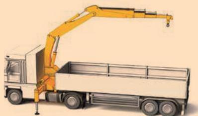
Grue de chargement montée derrière la cabine
