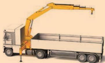
Grue de chargement montée derrière la cabine
