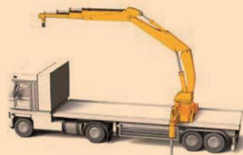
Grue de chargement montée en position centrale
