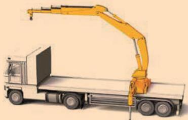
Grue de chargement montée en position centrale
